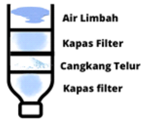
Gambar 3. 2 Ilustrasi Skema Filter Air menggunakan Botol plastik
